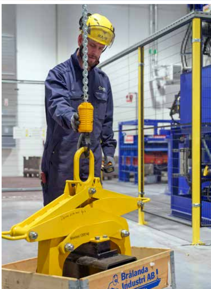
Tom Andersson, Cyclife, i färd med att lyfta metallgöt. Lyftsaxen för göt hänger i KBK lättlastsystemet.
