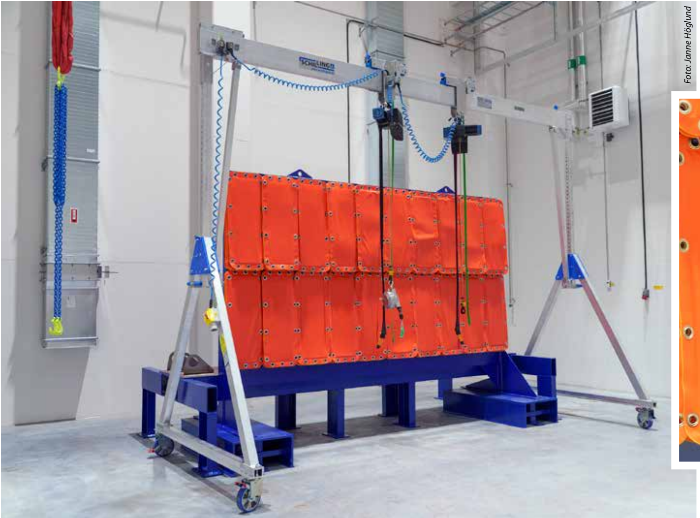
Den mobila portalkranen vid en strålskyddsvägg med blymattor (röda), för minskad strålningsrisk.
