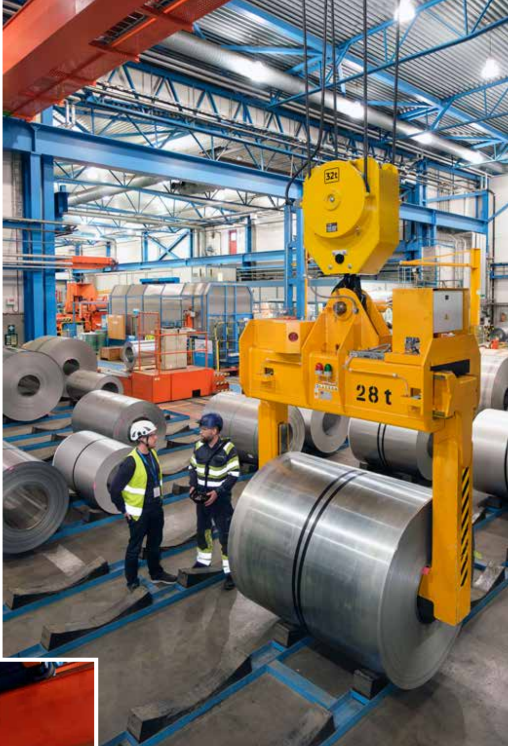
Traversen lyfter cirka 6000 coil-rullar per år.
