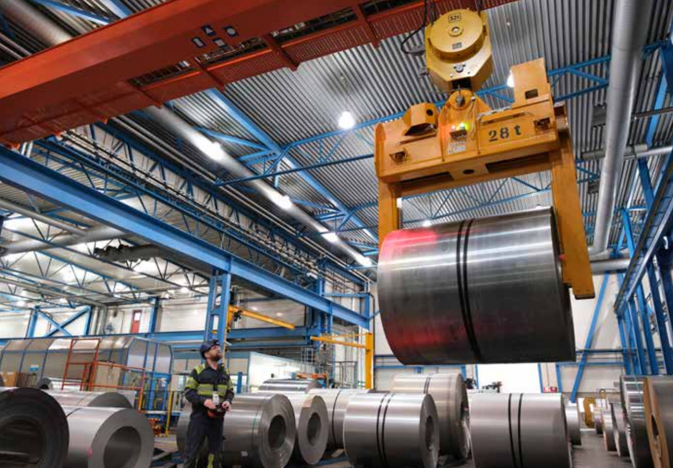
De stora rullarna med rostfritt band kan väga upp till 25 ton.
