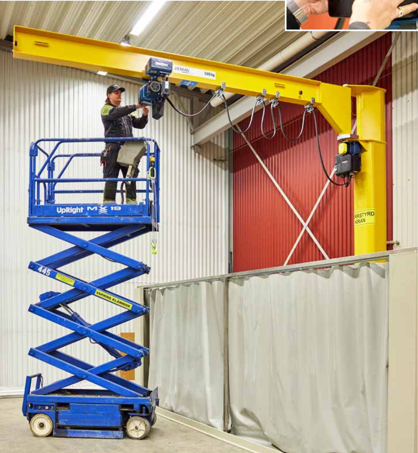
Den nya svängkranen är motordriven, med 500 kg lastkapacitet och radiostyrning.
