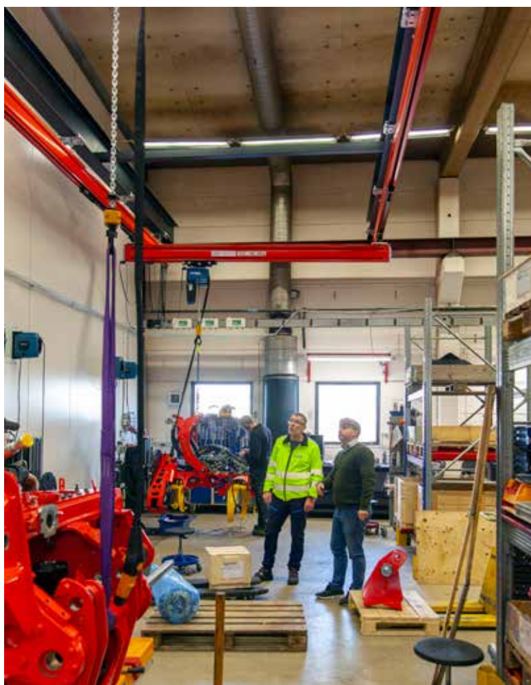
Med hjälp av KBK lättlastanläggningen transporterar man enkelt in materiel till montageplatserna.
