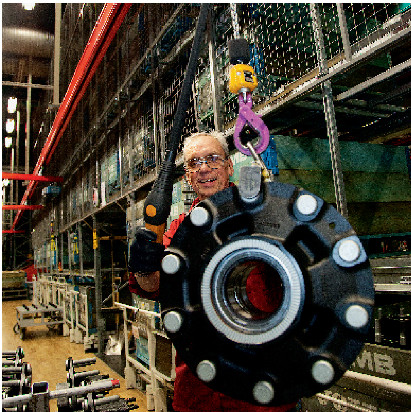
Med hjälp av Demateks lättlastsystem KBK lyfter Meritors Christer Wretlund enkelt ett nav till en bakaxel.
