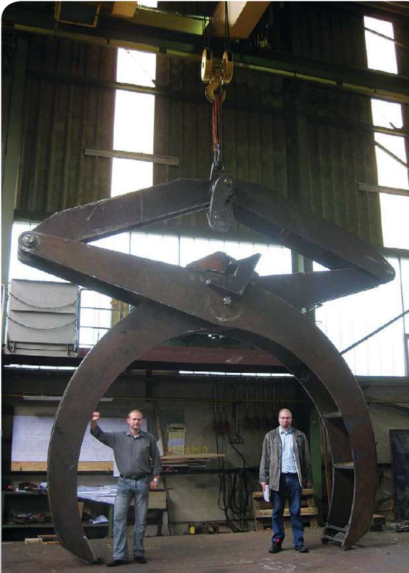
Mechanische Zange zum Greifen von Pipeline-Rohren unter Wasser. Mechanical tong for submarine pipeline tubes.
