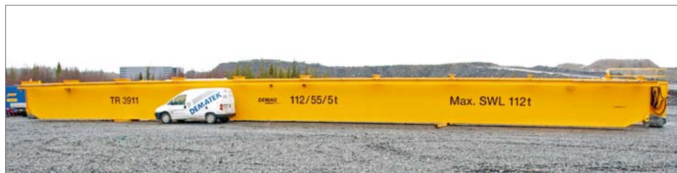
De största traverserna installerades i malningen. På bilden syns en av de mäktiga pjäserna för 112/55/5 tons last och med en spännvidd om 38 meter.
