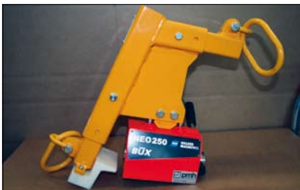
Lyftverktyg, specialkonstruerat för att byta axlar på Scania i Södertälje.
